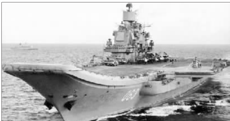
“库兹涅佐夫海军元帅”号是俄罗斯(前苏联)建造的第一艘可搭载固定翼飞机的航空母舰。该舰曾三易舰名，于1991年正式服役。该舰配备有滑跃式飞行甲板，舰上所装备的武器系统齐全，威力强大。满载排水
