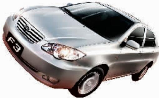
比亚迪F3的设计理念借鉴了国外汽车发展的成功经验及模式，动力与悬挂部分，采用了东安三菱生产的4g18排量1.6升顶置单凸轮轴(sohc)、四缸16气门发动机。比亚迪F3技术成熟，省油经济，最大功率73.5千瓦，最大扭矩134牛米，百公里油耗6升左右。
