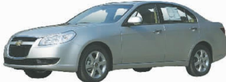
景程此次推出的2010款雪佛兰景程1.8L车型最大的变化之处就是搭载了来自科鲁兹的1.8L自然吸气发动机，这款发动机最大功率和最大扭矩分别达到105kw和177Nm，升功率值达58kw/L。
