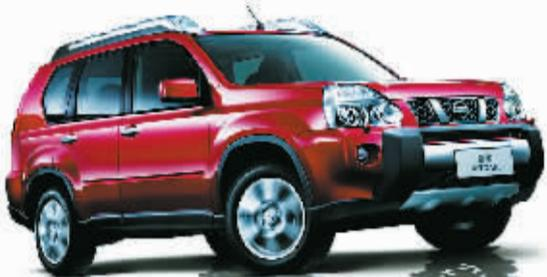
奇骏采用了全新的智能全模式四驱系统,具备同级别中最卓越的性能。独特的“4x4-i”智能全模式四驱系统具有三个不同的模式:两驱模式可以在日常驾驶中有效地降低燃油消耗;在自动四驱模式下,系统就会自动判断驾驶者的意图以及实际的路况,在发现车轮打滑的时候将扭矩自动分配到需要扭矩的车轮上;而锁定四驱模式,则可以将前后轮的扭矩锁定在约 50:50 上。
