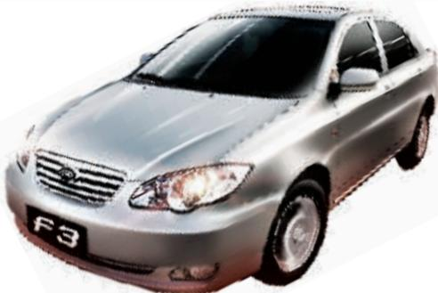
比亚迪F3的设计理念借鉴了国外汽车发展的成功经验及模式,动力与悬挂部分,采用了东安三菱生产的4G18排量1.6升顶置单凸轮轴(sohc)、四缸16气门发动机。比亚迪F3技术成熟,省油经济,最大功率73.5kW,最大扭矩134N·m,百公里油耗6升左右。
