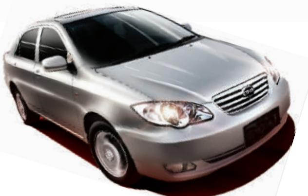
比亚迪F3的设计理念借鉴了国外汽车发展的成功经验及模式，动力与悬挂部分，采用了东安三菱生产的4G18排量1.6升顶置单凸轮轴（sohc）、四缸16气门发动机。比亚迪F3技术成熟，省油经济，最大功率73.5kW，最大扭矩134N·m，百公里油耗6升左右。
