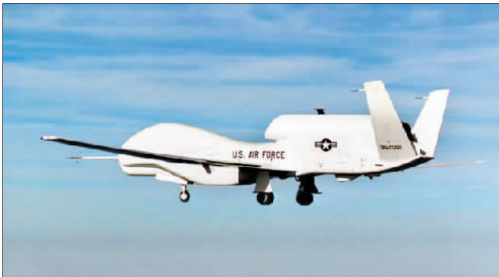
美国“全球鹰”无人侦察机可在两万米高空(属于临近空间范畴)飞行。
