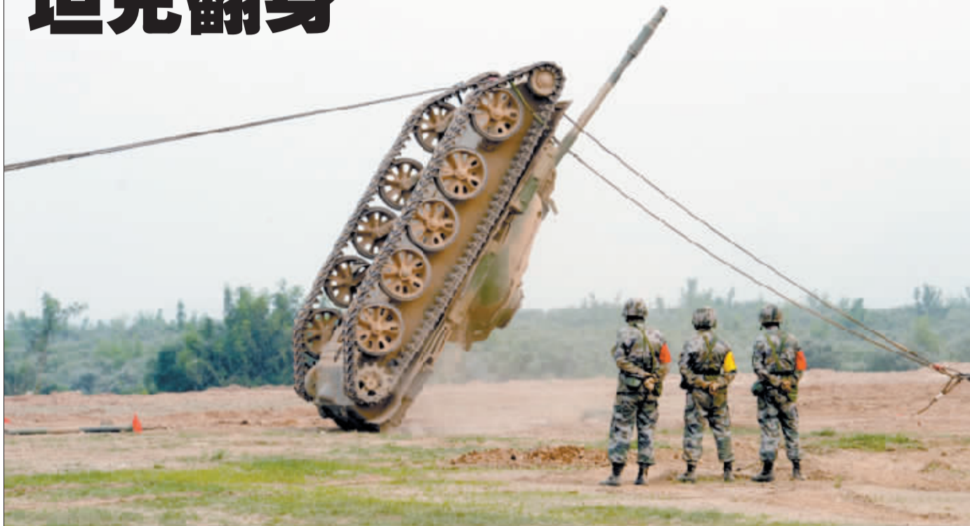
近日,在北京军区基础比武现场,装甲抢救车牵引训练坦克的一幕颇为震撼。画面上,一辆原本倒扣在地的坦克在抢救车的牵引钢缆的作用下,一点点挪动车身,最终成功翻转过来。在这一过程中,两辆装甲抢救车相互配合,牵引动作一气呵成。
