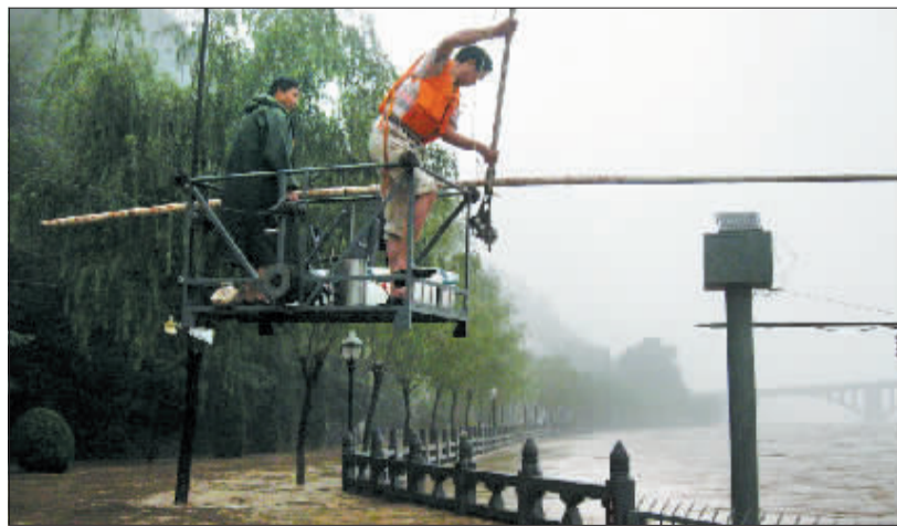
测量人员在龙门石窟景区冒雨测量伊河流量。
