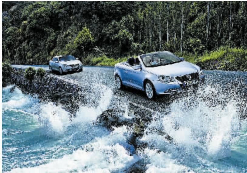
水路时，应停车查看水深、流速、流向和水底情况，不能冒险涉水。涉水的深度应不大于汽车的最大涉水深度。涉水时应将汽车的分电器、点火线圈等电气设备进行防水保护包扎。对于部分空气滤清器在车身下部的汽车，涉水深度不应超过空气滤清器进气口，否则您的车会变成水泵机，发动机的连杆、活塞都会损坏。
