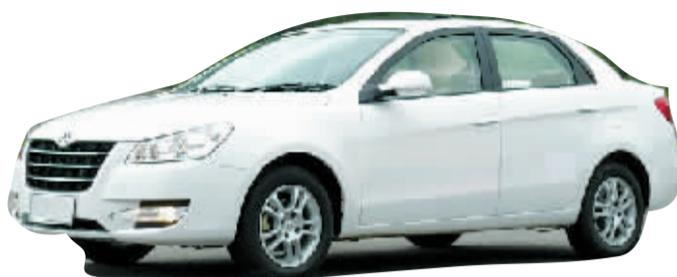
东风风神 S30 是东风集团旗下的首款自主轿车,它的外形设计是与意大利乔治亚罗设计公司共同完成。S30 的外形大气,它采用了大嘴式的前脸设计,头灯组采用了鹰眼式造型,另外它的刀刀式雾灯造型及机器盖上凸起的肌肉线条更具力量感,而俯冲式的腰线造型及厚实的尾部效果也同样呼应了它的动感效果,整体给人带来的视觉效果大气、沉稳。它的车身尺寸为 4502/1740/1465 (mm),轴距为 2610mm,这种空间设计非常符合时下的 A 级轿车标准,中等身材的乘员在车内丝毫没有压抑感,而它那 487L 的行李箱空间完全可以满足日常使用。
