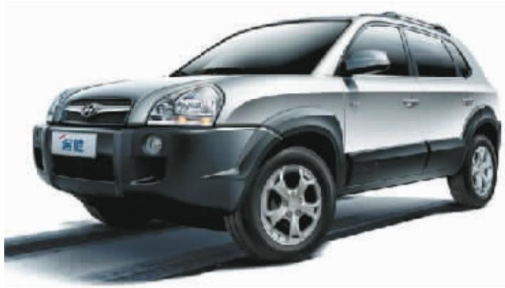
作为一款经典城市SUV车型，途胜2.0L车型搭载了一款先进的β-DOHC CVVT发动机。该发动机采用的CVVT连续可变的气门正时系统，能够随着发动机工况的变化调整气门的开闭时间，从而确保对节气门的变化做出迅速反应，可实现发动机在怠速状态时稳定燃烧，在起步、加速、爬坡获得更大的扭矩，高速行驶时提高发动机的工作效率。发动机在中等工况时(中速匀速行驶)，CVVT会相对延迟进气门打开时间，减小气门重叠角，降低燃油消耗和污染排放，所以手动两驱车型的综合工况油耗仅为8.3L/100km。与其他城市SUV不同，途胜各个细节的设计体现了设计者的人文关怀，如途胜的后窗玻璃采用独立开启式，取放物品简单方便；折叠潜藏式后座椅可改变随意车内空间布局，方便用户储放物品。作为一款城市SUV车型，途胜具有媲美轿车的舒适性配置：电动天窗、自动空调、倒车雷达、带MP3功能的CD、手机免提系统、真皮坐椅、高保真6扬声器音响等等。值得一提的，还有途胜的静谧性，其路噪、胎噪、发动机声音，都被很好地遮盖，直到4000转以上，发动机声音才比较清晰但仍很柔和、可接受地传到驾驶室内。
