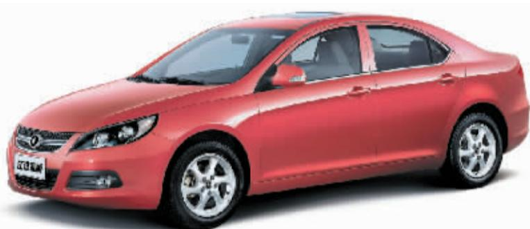
江淮和悦采用的全承载车身结构和 40% 高强度钢板，前排配备预紧式安全带和双安全气囊；通过先进的电感器精确感应，能迅速作出正确反应，在人体扑到气囊上之前将气囊完全打开，配合安全带的使用，最大限度降低正面冲撞对驾驶人员造成的伤害。而应用的博世全球最新 8.1 版本 ABS+EBD 系统，体积更小、重量更轻，且紧急制动时的踏板震动反馈更小，全面提升主动安全性和驾驶舒适性。
