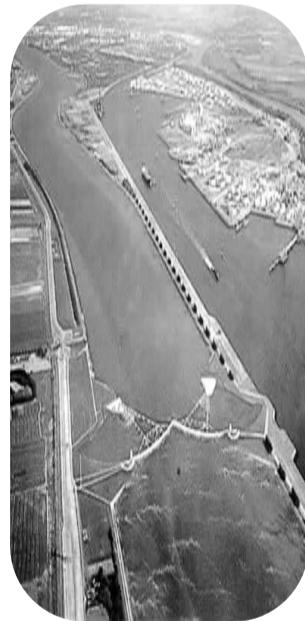
1953年，荷兰发生了特大洪灾，导致大约1800人丧生。当局意识到，必须建造防洪工程，工程的关键是堵截通向安特卫普市和鹿特丹市的河口。其基本前提是尽量减少海堤坝的决堤。该工程工程量非常大，整个海岸线都改变了。整个工程包括12个重大项目，1954年开始设计，1956年动工，1986年宣布竣工并正式启用，共耗资120亿荷兰盾。一些海湾的入口被大坝封闭，使得海岸线缩短了700公里。三角洲工程使荷兰西南部地区摆脱了水患的困扰，改善了鹿特丹至比利时安特卫普的交通，促进了该地区乃至全荷兰的经济发展。
