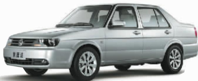
新捷达在捷达基因的基础上,延续了德国大众轿车的前沿设计理念并结合最新的造型设计哲学,对外观和内饰等方面完成了16项全新设计改进;对54种零件进行了改进提升,完成了161项质量改进。新捷达长宽高分别为4415mm×1674mm×1415mm,轴距为2471mm。前低后高且更富张力的视觉冲击,锐利线条配合柔和曲面过渡效果的组合更为新捷达带来一种冷峻的动感。
