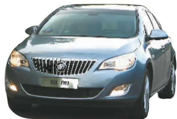
胎：15/16英寸大刹车盘制动力更强，205/60 R16, 215/50 R17及225/50 R17三种不同规格的轮胎满足多重需求。
