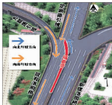
洛阳桥对接立交桥示意图
