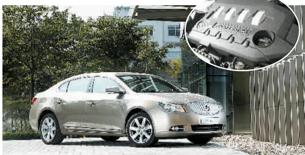
放兼于一身。这款2.4L SIDI智能直喷发动机最大功率137kW/6200 rpm，最大扭矩240N·m/4800rpm，比上一代同排量机型，功率大幅提升9.6%，扭矩提升6.7%。在其强劲驱动下，别克“双君”0~100km/h加速成绩提高3%以上，最高车速同时获得提升；而混合工况下百公里油耗则下降了2.2%，冷启动排放更大幅降低了25%，充分体现了“更
