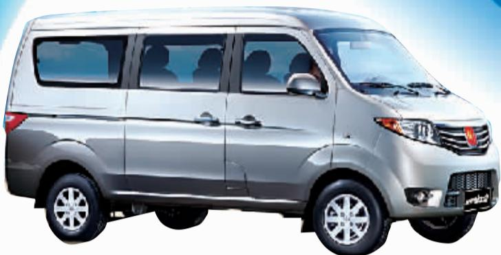
长安金牛星是首款悬挂长安商用车金牛车标的车型。它的车长、宽、高分别为4110mm、1690mm、1930mm，车内部空间最大可达4.3m<sup>3</sup>，在同类微车中首屈一指，轴距则为2605mm，载重量达到700kg。
