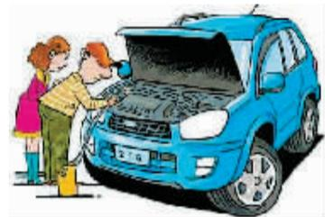
四是检查燃油喷射系统,如燃油压力、喷油器工作情况。五是检查点火系统,尤其是爆震传感器和点火器的工作是否正常。六是检查节气门位置传感器是否正常。七是检查EFI电路及与燃油喷射有关的元件的工作情况。最后还要检查汽缸压力、气门间隙、火花塞工作情况及配气相位等项目。
