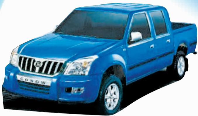
全球首创特加长货厢，整车车身最长可达5.81米，仅货厢长度就达2.035米，加强型大梁和钢板，载货更多，更方便。
