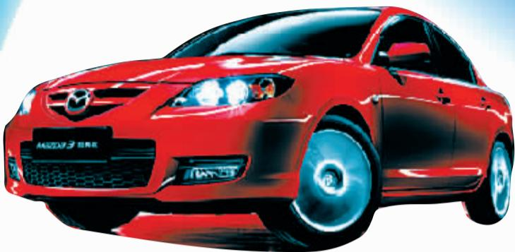
马自达3是由马自达、福特汽车和瑞典volvo三方联合开发设计的，与volvos40及福特新款福克斯(focus)共用底盘。车体前部采用了volvo的车架构造，3H车身强化设计提高了安全性，尾部结构与目前的福克斯接近。悬架减震系统也基本上与福克斯相同，前、后分别采用麦花臣臂杆式及多连杆式结构。
