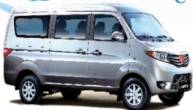
长安金牛星是首款悬挂长安商用车金牛车标的车型。它的整车尺寸为4110mm×1690mm×1930mm，车内空间最高可达4.3m<sup>3</sup>，轴距为2605mm，载重量达到700kg。
