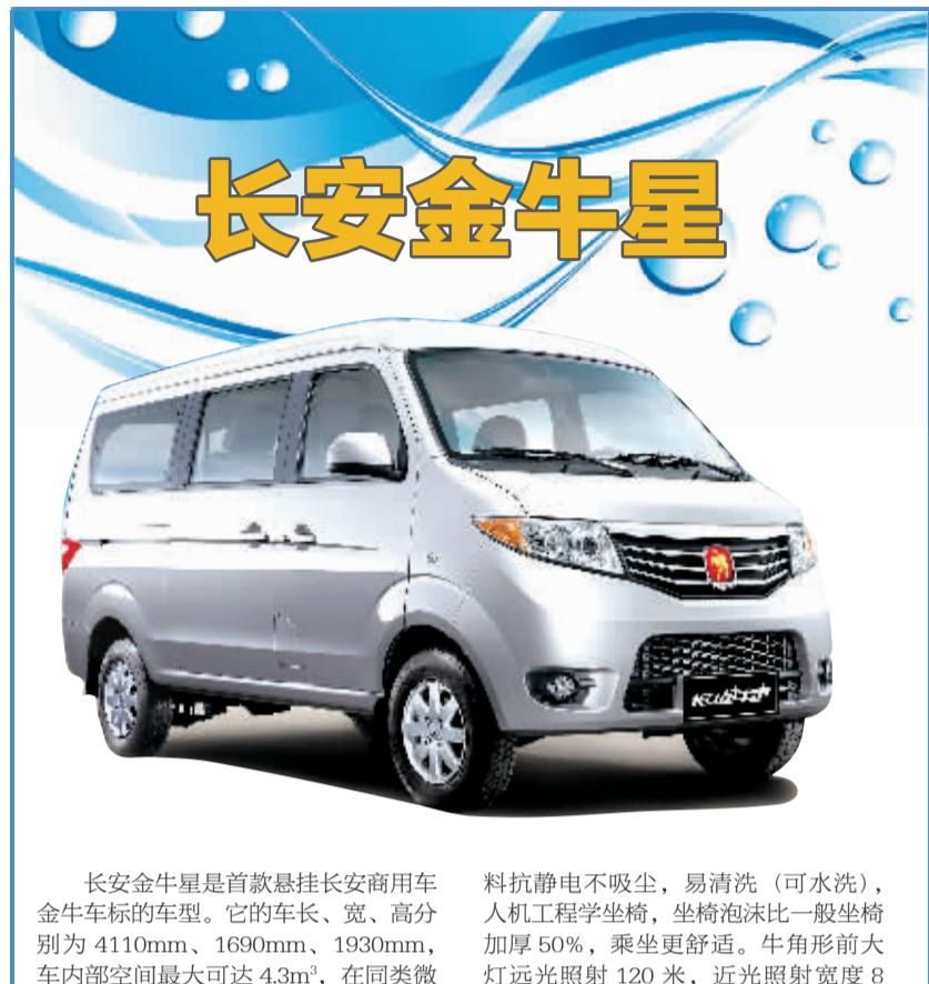
长安金牛星是首款悬挂长安商用车金牛车标的车型。它的车长、宽、高分别为4110mm、1690mm、1930mm，车内部空间最大可达4.3m<sup>3</sup>，在同类微车中首屈一指。轴距则为2605mm，载重量达到700kg。该车采用了前麦弗逊独立悬挂，低配车型采用后钢板弹簧非独立悬挂，而高配的豪华型则采用了螺旋弹簧非独立悬挂。发动机则是1.3L的直列四缸发动机，采用铃木技术，最大功率和扭矩分别为60kW和102N·m，最高时速可达135km。
