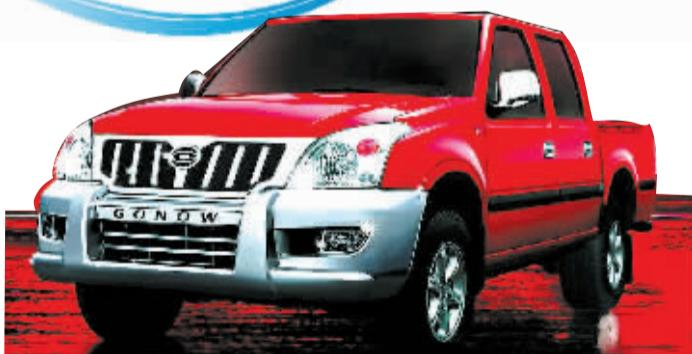
全球首创特加长货厢,整车车身最长可达5.81米,仅货厢长度就达2.035米,加强型大梁和钢板,载货更多,更方便。
