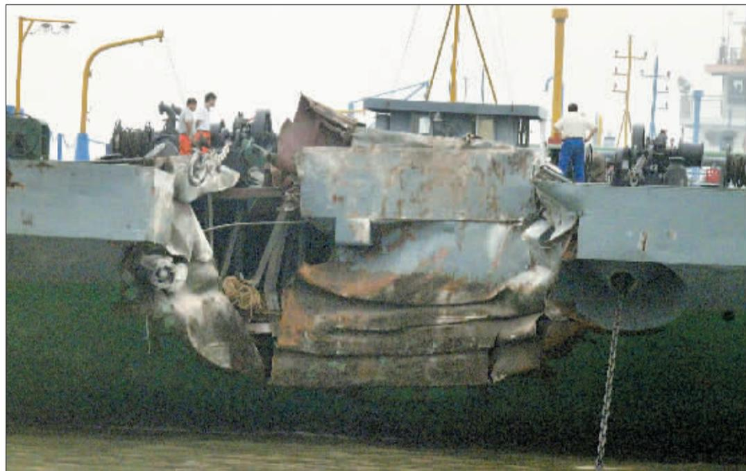
这是碰撞桥墩的“长江62036”驳船船头。6月6日早晨6时50分许,长江武汉段江面大雾,“长江62036”号船队拖4空油驳(岳阳到南京)下行通过武汉长江大桥时,碰撞到武汉长江大桥七号桥墩,目前未造成人员伤亡和原油泄漏,事故原因正在调查中。
