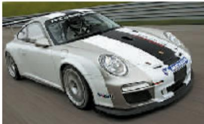
新 911 GT3 Cup 赛车基于轻量化 911 GT3 RS 跑车发展而来,依旧搭载经典的 3.8 升 6 缸水平对置发动机。另外,该车使用了 18×9.5 英寸、18×12 英寸前后轮圈,7 向可调防倾杆以及陶瓷复合刹车盘。随后,我们将在包括保时捷赛事在内的一系列 GT 赛事中见到它的身影。(林林)
