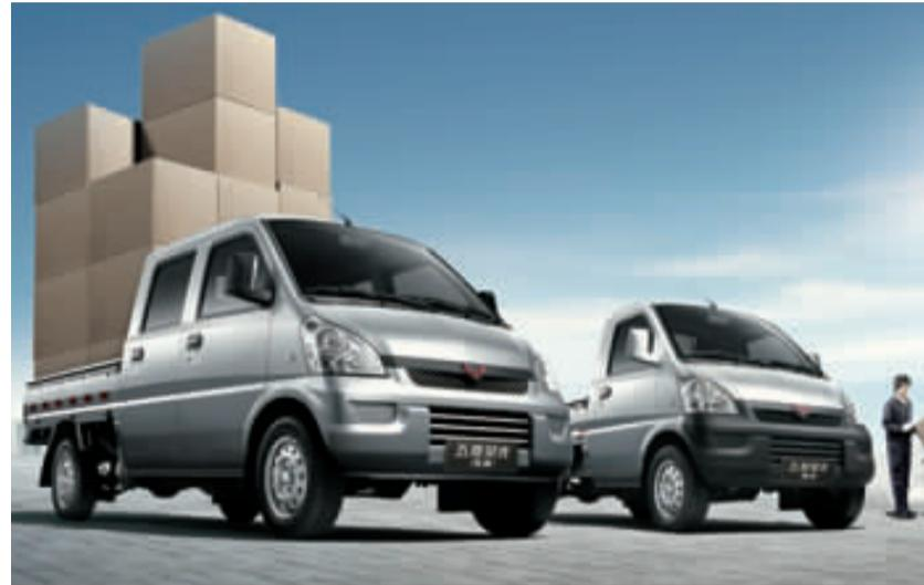
荣光小卡采用了一次冲压成型大梁，坚固结实；双排座大梁厚度140mm；单排还采用加强型副梁设计，厚度达210mm，承载能力大大提升。荣光小卡整车动力全新匹配优化设计，传动系速比调整——变速器一挡速比由3.769提高到3.857，后桥速比由5.125提高到5.286，扭矩输出增加了5%，增强了在低速、爬坡时的动力性能。
