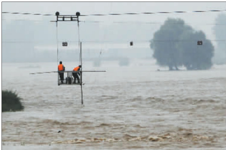
龙门镇水文站的工作人员登上吊箱,测量水深和流速。
