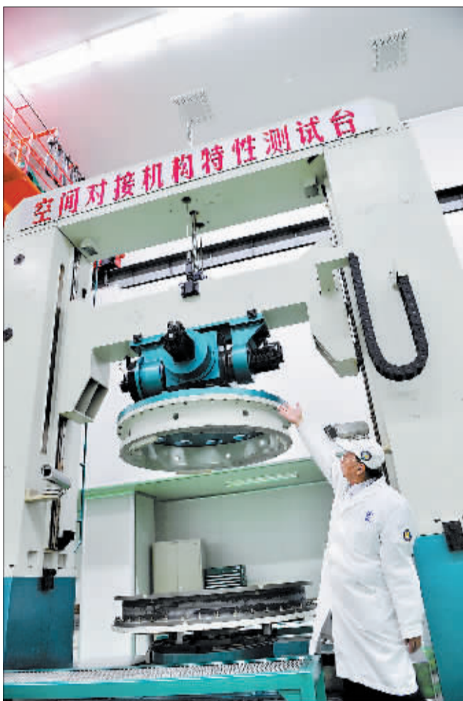
位于上海航天技术研究院805所的空间对接机构特性测试台。新华社记者 张建松 摄
