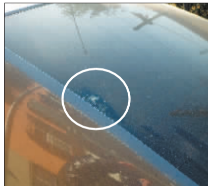
宋女士汽车后挡风玻璃上的裂缝。
