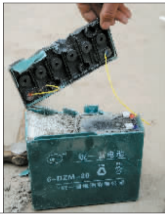
统一蓄电池里面竟是水泥芯。
