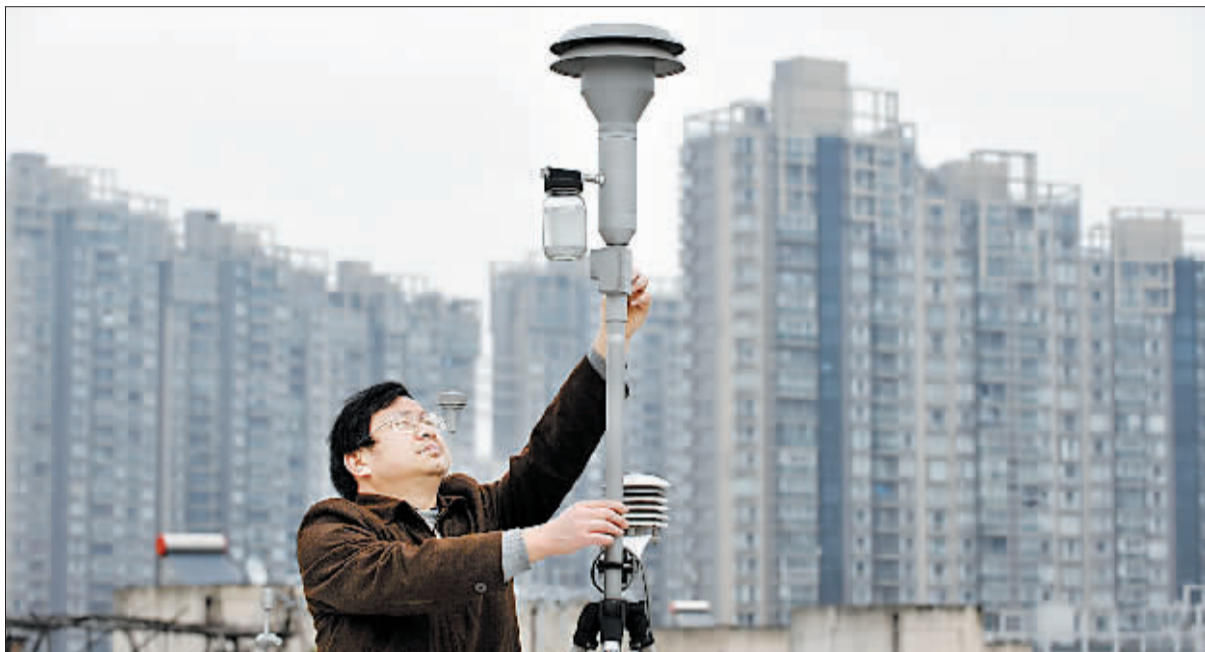
3月1日,杭州市环境监测站的工作人员在调整PM2.5监测设备。 新华社记者 黄宗治 摄
