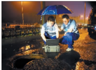
使用多探头相关仪检测定鼎路 DN800 管道。
