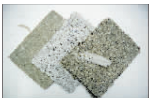
2008年7月30日,在菲律宾拍摄的用鸡毛和水泥制成的板材。
