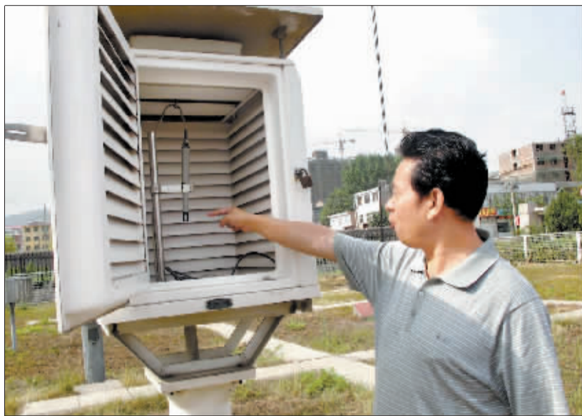
百叶箱中的自动温湿度传感器会将测到的数据自动上传。
