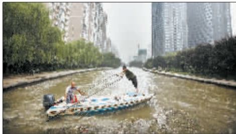
焊上“切割架”,冲锋舟成镰刀。
