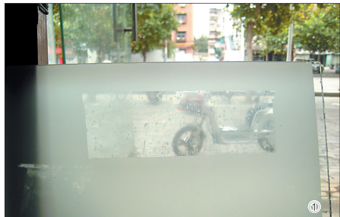
透过贴有透明胶带的磨砂玻璃，能清楚地看到远处的电动车，(图①)在近处看报纸也不是问题(图②)。
