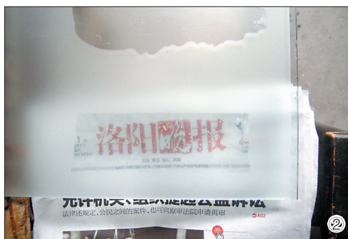
透过贴有透明胶带的磨砂玻璃，能清楚地看到远处的电动车，(图①)在近处看报纸也不是问题(图②)。
