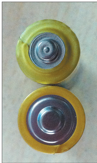
问题电池(上)较细,且正极金属裸露面积较小。
