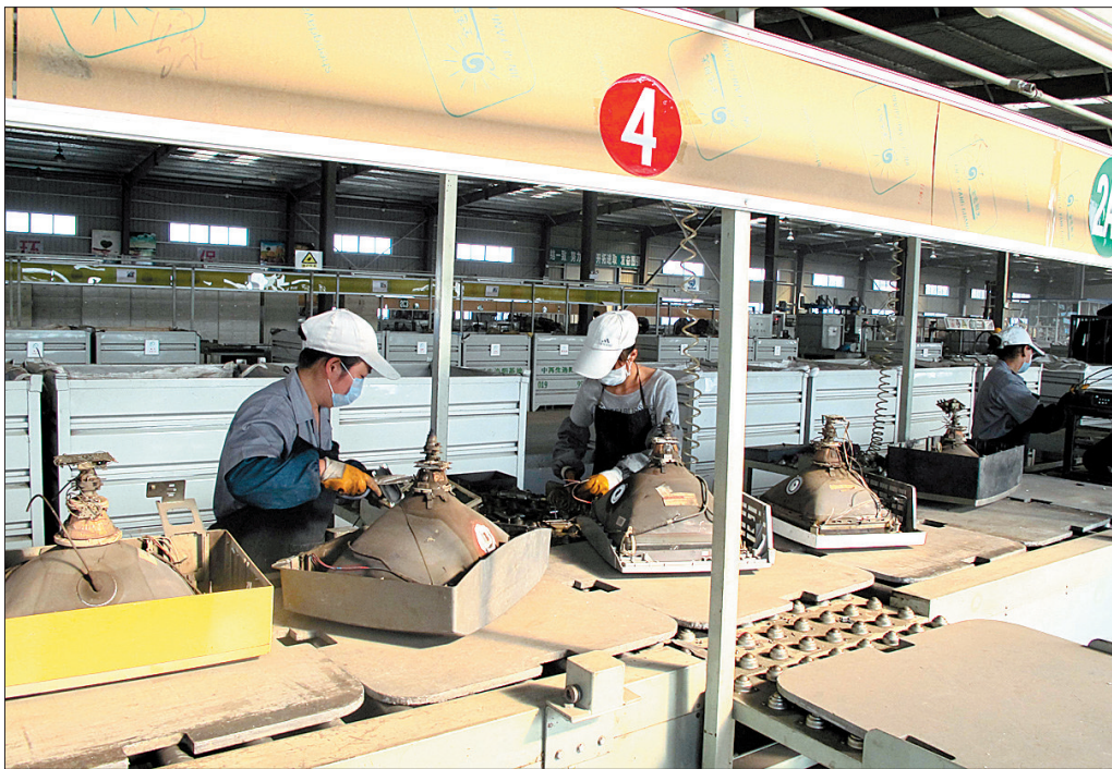
流水线上，工人对废旧电视进行简单拆解。
