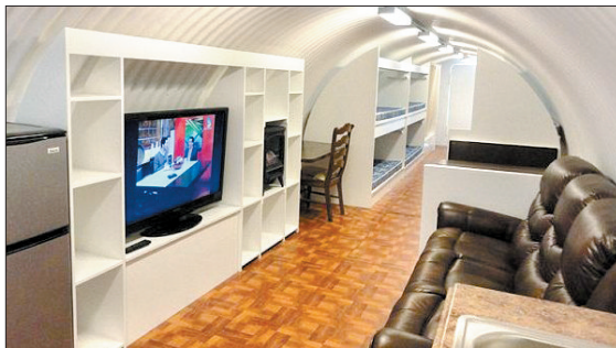
该防空舱由一个长约九点八米、直径约三米的巨大金属管道改造而成。(据新华网)
