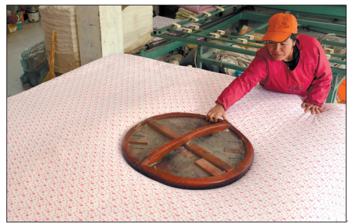
使用磨棉器将装套后的棉花展平。
