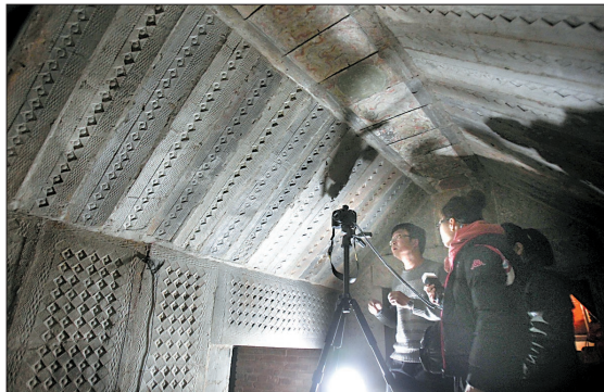
工作人员用多光谱无损照相机给壁画拍照。
