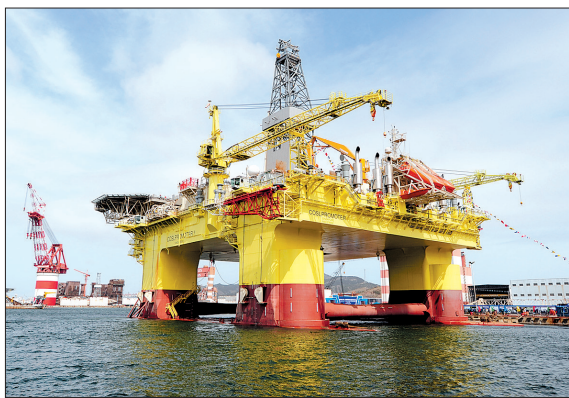
中海油深水半潜式钻井平台。(本版图片均据新华社)
