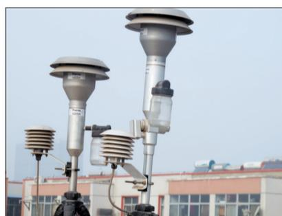
楼顶设备采集空气样本,其中右侧的设备用于PM2.5空气采样
