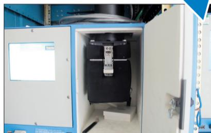
在屋顶采集的空气样本通过管道直接被送入室内监测仪器
