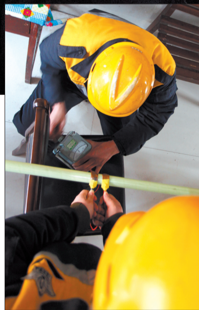
▲出发前,给绝缘杆作绝缘测试
