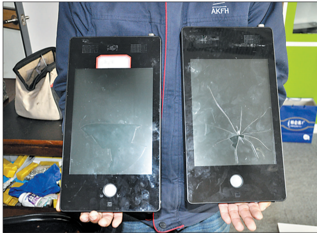
“电梯卫士”系统电子屏已碎裂
