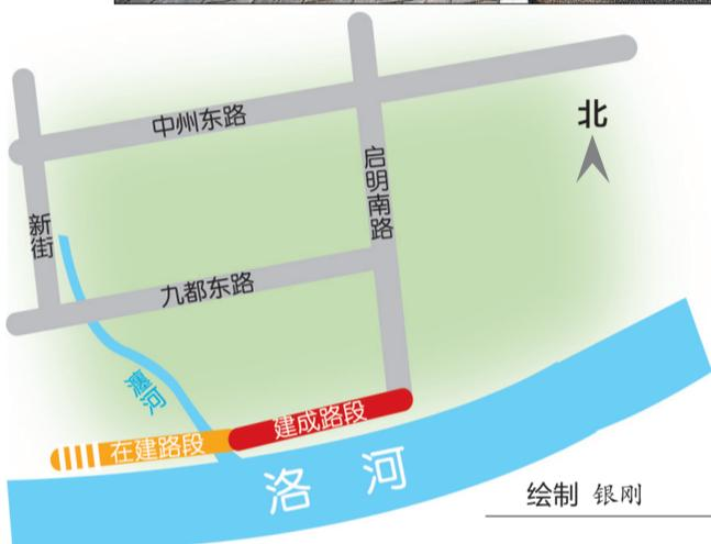
备受关注的滨河北路建设工程又有新进展,瀍河桥至启明南路段建成并具备通车条件。该路段总长度约952米、红线宽20米,包含两条4米宽的人行道和一条12米宽的车行道,道路设计行车时速为30公里。由于目前路灯、交通信号灯等配套设施尚未安装,市民夜间行车最好还走九都路。另外,滨河北路瀍河桥至御博路段正在加紧施工中。
