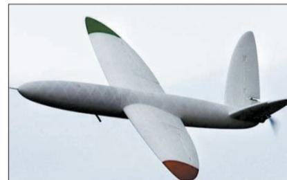
无人驾驶激光烧结飞机, 所有部件均由尼龙激光烧结打印机打印而成。
