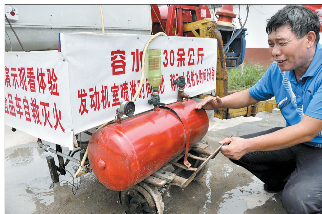
小轿车的储水罐只需要携带30公斤水，就可以供应发动机室持续喷淋50秒、水枪喷水3分钟，实现灭火
