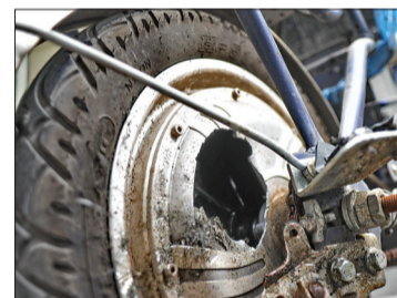
电动车后轮轮盘上“炸”出的大洞
